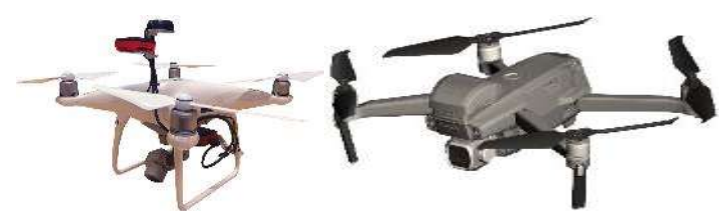
Дрон с высокоточным ГНСС приемником (GPS, Glonass, Galileo)
